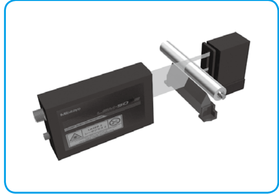
滚筒的外径与跳动的同时测量
