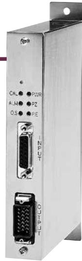
● PSU-200将本公司直线栅尺输出的正弦波信号分割为最少4份、最多200份，并将其转换为方波信号并输出，这样NC反馈系统、测量控制装置等可与直线栅尺一起使用，以完成高精度定位。
