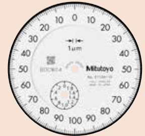
分度值: 0.001mm, 2113A-10 测量范围: 2mm 防震型 宝石轴承型
