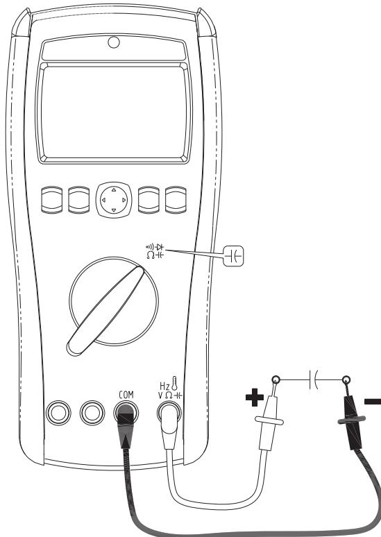
量测电容的量程最高达 40 mF。自动量程最高只到 400 uF。针对高电容量测，按下量程 (RANGE) 钮手动选择 mF 量程。
