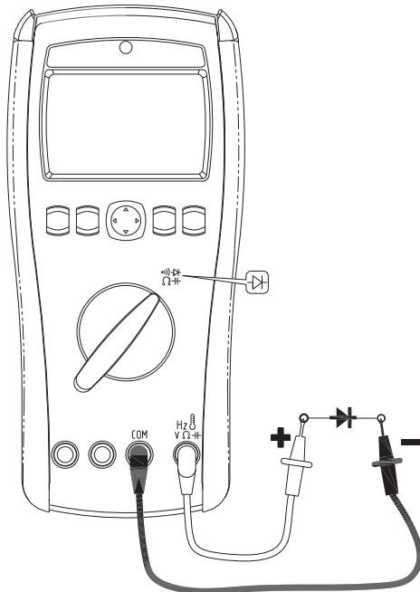
使用二极体测试功能来检查二极体、电晶体、矽控整流器 (SCR) 和其他半导体装置。此功能透过传送电流穿过接面，接着量测接面的压降来测试半导体接面。
