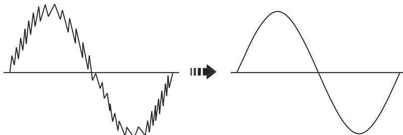
在高频抑制模式下，搭配低通滤波器进行 AC 量测。低通滤波器的截止频率 (-3dB 点) 为 800Hz。
