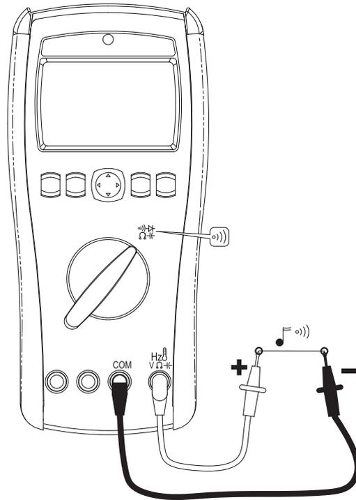
导通检测配备蜂鸣器，通路十蜂鸣器将发出声响。蜂鸣器允许您在不看显示萤幕之情况下快速检查导通。
