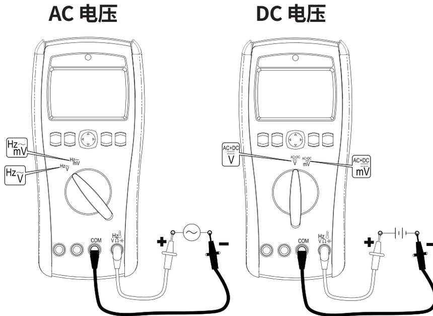
为了测量 DCmV 时之最佳准确度，请将探针尖端接触并读取 DC 偏移值。如有必要，您可以使用相对 ( $\Delta$ ) 模式自动减去该值。
