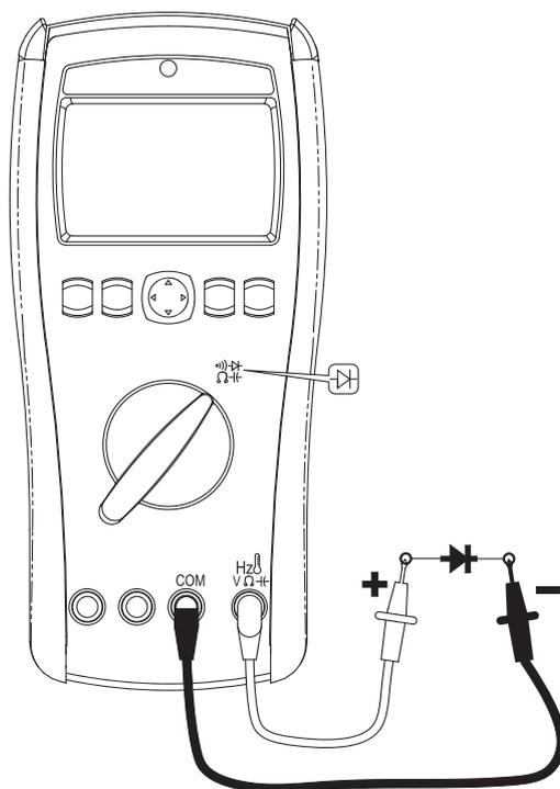
使用二极管测试以检测二极管、晶体管、可控矽整流器 (SCR) 和其他半导体器件。
