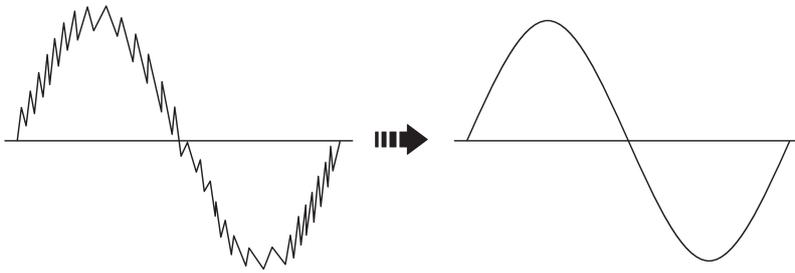
高频抑制模式于交流电压测量中使用低通滤波器。低通滤波器之截止频率（-3dB 点）为 800Hz。欲使用 HFR 模式，请按 HFR 按钮以于 AC 测量中搭载低通滤波器。
