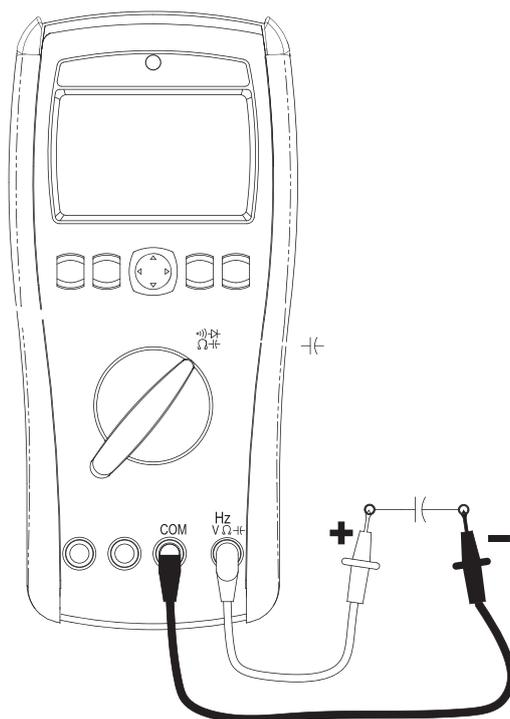
测量电容：范围为 40nF、400nF、4uF、40uF、400uF、4mF 与 40mF。
