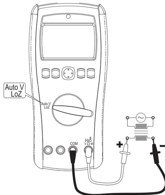
为消除虚假电压，仪器 LoZ 模式将于在测试线间呈现低阻抗，以获得更准确之测量。LoZ 电压之测量范围为 400V 和 1000V。此模式中，仪器将自动测量输入信号为交流或直流电并确定范围。
