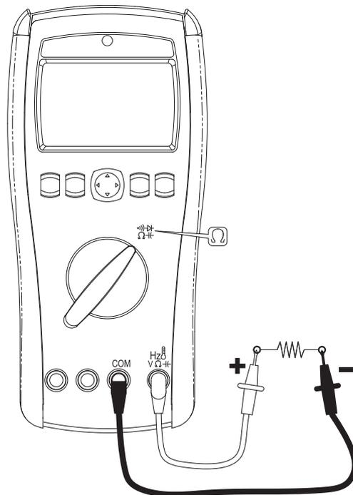
测量电阻范围为 400Ω、4kΩ、40kΩ、400kΩ、4MΩ、40MΩ。
