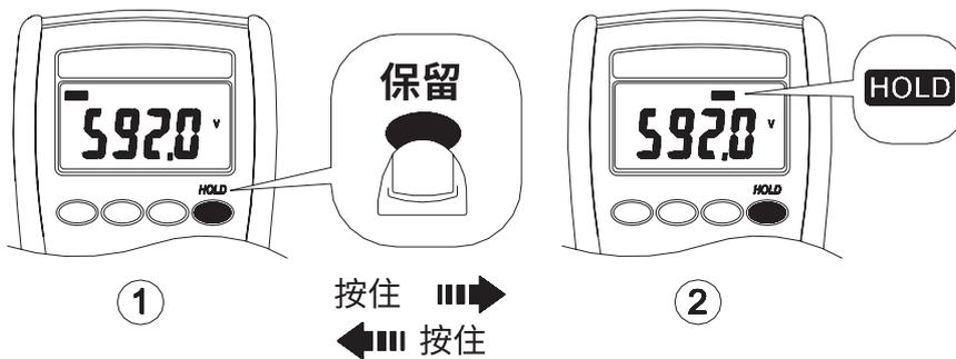
注 - 按下保留钮切换进入和离开萤幕的保留模式。最大值/最小值 (MAX / MIN) 功能在萤幕的保留启用中时无法使用。
