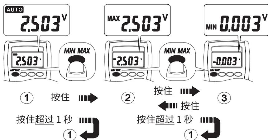
注 - 在最小值最大值 (MIN MAX) 模式下按保留 (HOLD) 键，让仪表停止更新最大值和最小值。萤幕的保留 (HOLD) 模式嵌套在最小值最大值 (MIN MAX) 模式中时萤幕的保留 (HOLD) 必须在最小值最大值 (MIN MAX) 模式前先释放。
