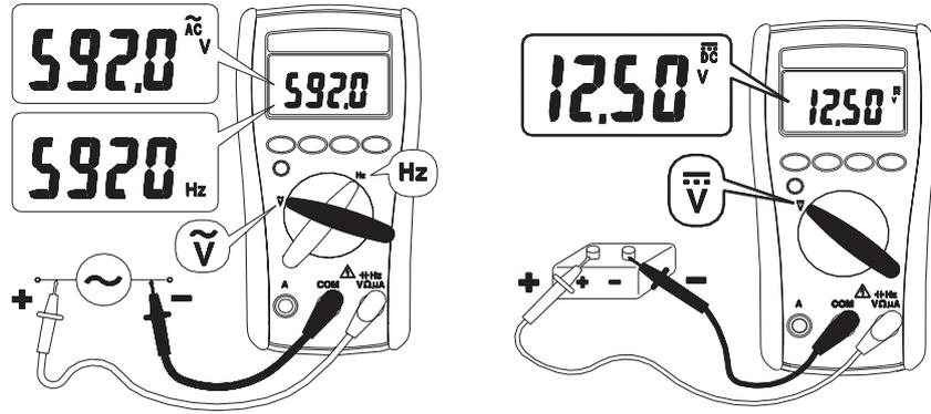
仪表测试棒为开路时，未归零萤幕读数为正常，不会影响到实际的量测准确度。仪表会显示为零或接近测试棒短路时的读数。在 AC 电压或电流读数中，读数安定下来的时间会在 AC 电压的低端和有效值机型的电流量程中增加到数秒。
