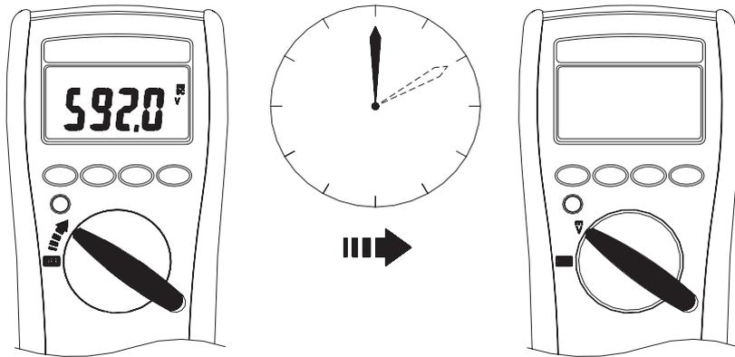
**注** - 若仪表闲置超过 10 分钟, 仪表就会自动关机。这种情形发生时, 仪表上 LCD 显示的状态就会储存起来。可以按任何按钮让仪表重新开机, LCD 会显示储存的状态。按下保留钮停用保留状态。
