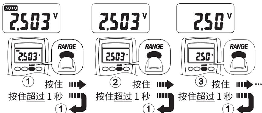
注 - 按下量程钮选择手动量程和改变量程。按一次量程钮，**AUTO** 图示就会关闭。按下量程钮选择适当的量程用于您想要进行的量测。按下量程钮并按住 1 秒可返回自动量程。
