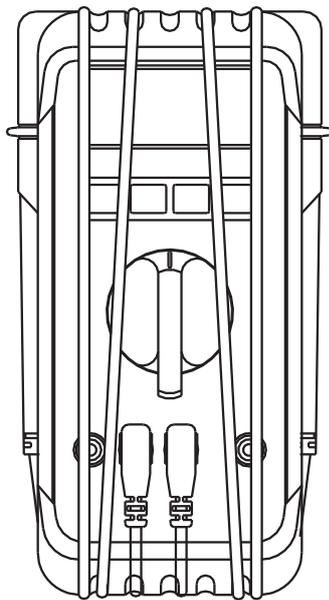
以测试线缠绕皮套, 储存测试探针。
