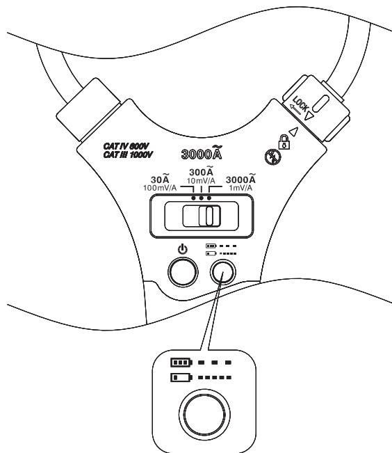
电池容量 $>2.5\text{V}$ ，电池容量指示灯慢速闪烁。
