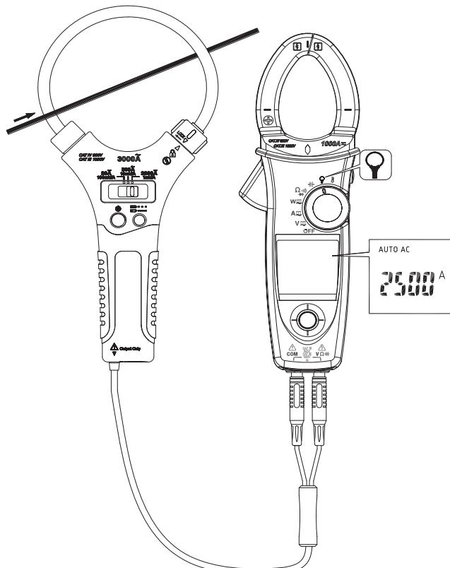
为获取正确读数，请将柔性鉤錶与具有柔性功能之鉤錶或DMM连接。将钳表或 DMM 设至 Flex 功能，并将柔性钳表之范围固定于 3000A。
