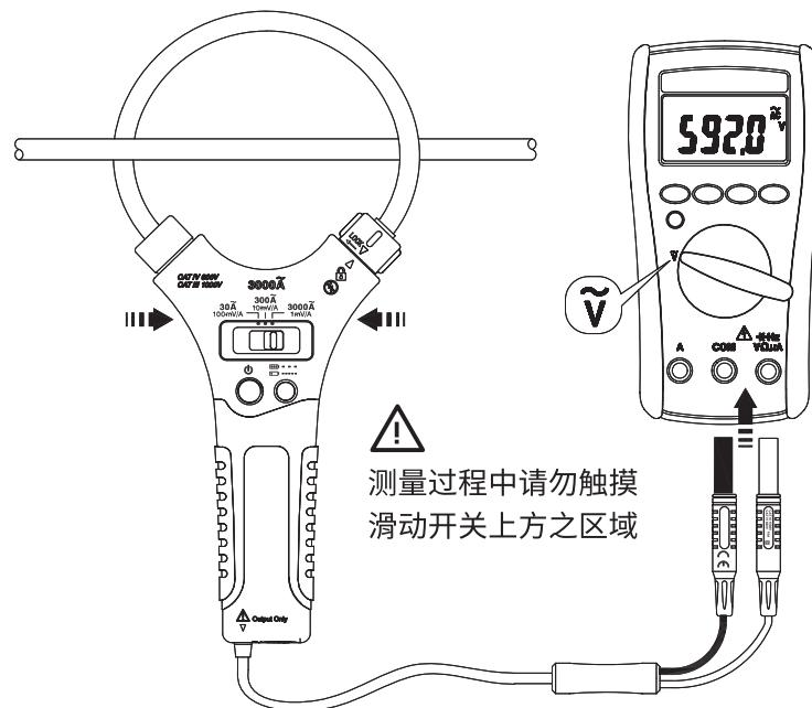
将 DMM 设定至 AC 3.000V 范围并将 sFlex-T 切换到合适的范围。依据”交流电流” 规格计算正确电流。
