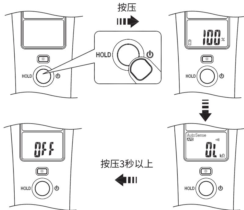
仪器将于通电时显示电池容量。请于显示<10%时更换电池
