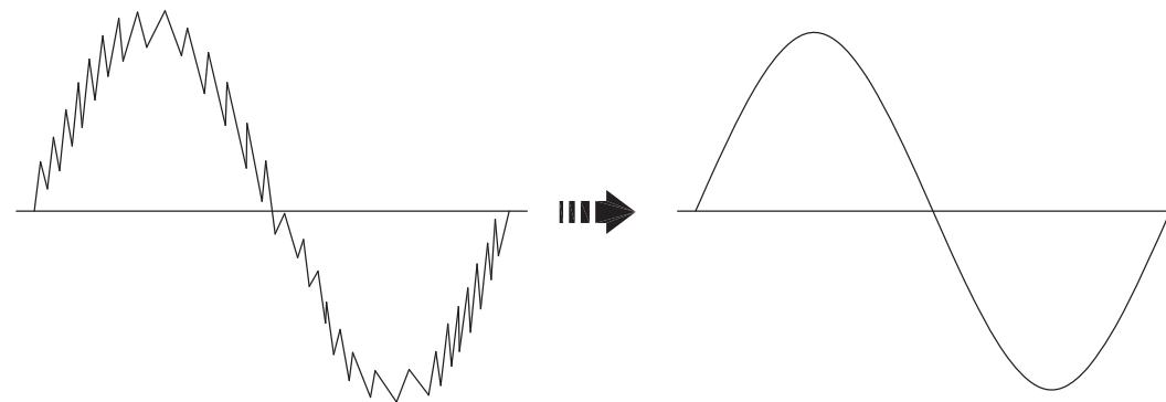
在高频抑制模式下，搭配低通滤波器进行 AC 量测。低通滤波器的截止频率（-3dB 点）为 800Hz。如欲采用 HFR 模式，按下 HFR 钮搭配低通滤波器进行 AC 量测。
