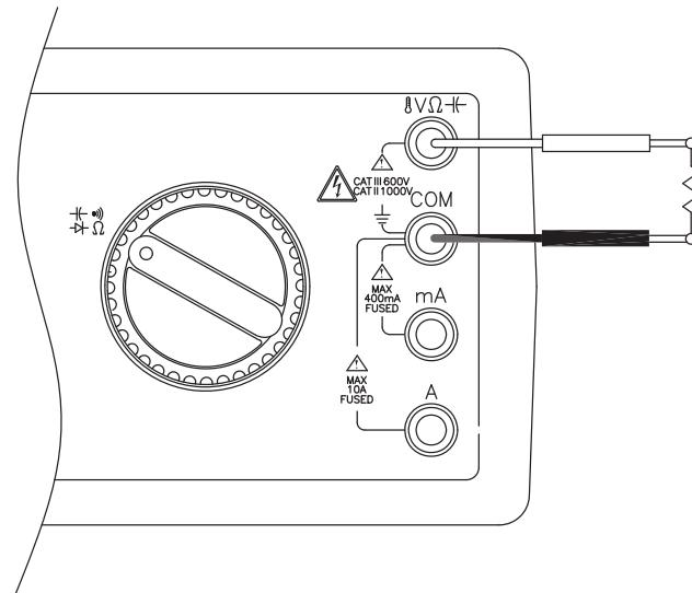
导通性检查的特点为蜂鸣器,每检查完一个电路就会响起。蜂鸣器让您无需紧盯萤幕,即可快速进行导通性检查。
