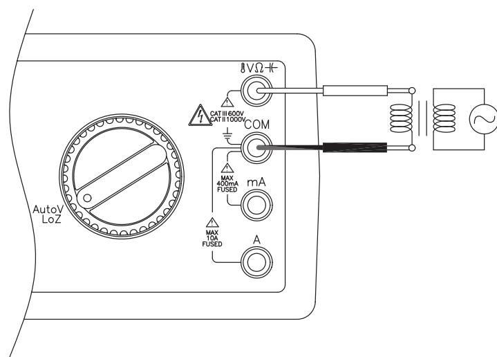
为消除假性电压, 在仪表的 LoZ 模式下, 测试棒的阻抗会变低, 以取得更准确的量测值。量测 LoZ 电压的量程为 400V 和 1000V。在 LoZ 模式下, 仪表会自动量测 AC 或 DC 输入讯号, 并决定量程。
