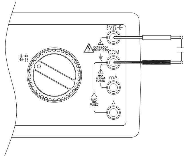
量测电容的量程为 40nF、400nF、4uF、40uF、400uF、4mF 和 40mF。
