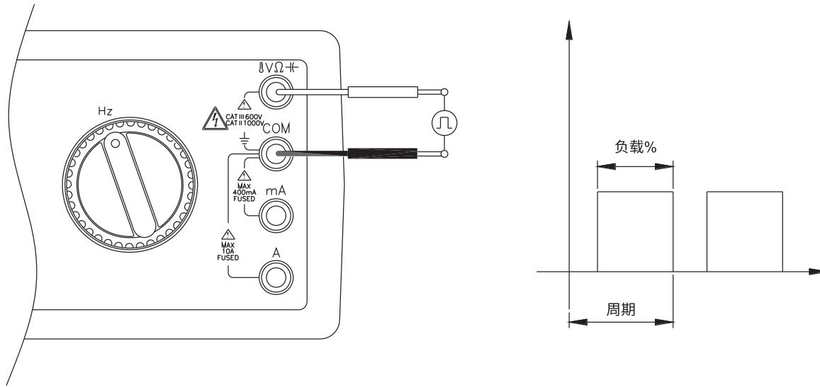
频率计数器的量程为 40Hz、400Hz、4kHz、40kHz、400kHz 和 4MHz。
