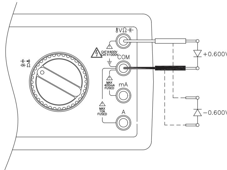
进行二极体测试来检查二极体、电晶体、矽控整流器(SCR)和其他半导体装置。此功能透过传送电流穿过接面,接着量测接面的压降来测试半导体接面。良好的矽接面可达到介于 0.5V 和 0.8V 间的压降。
