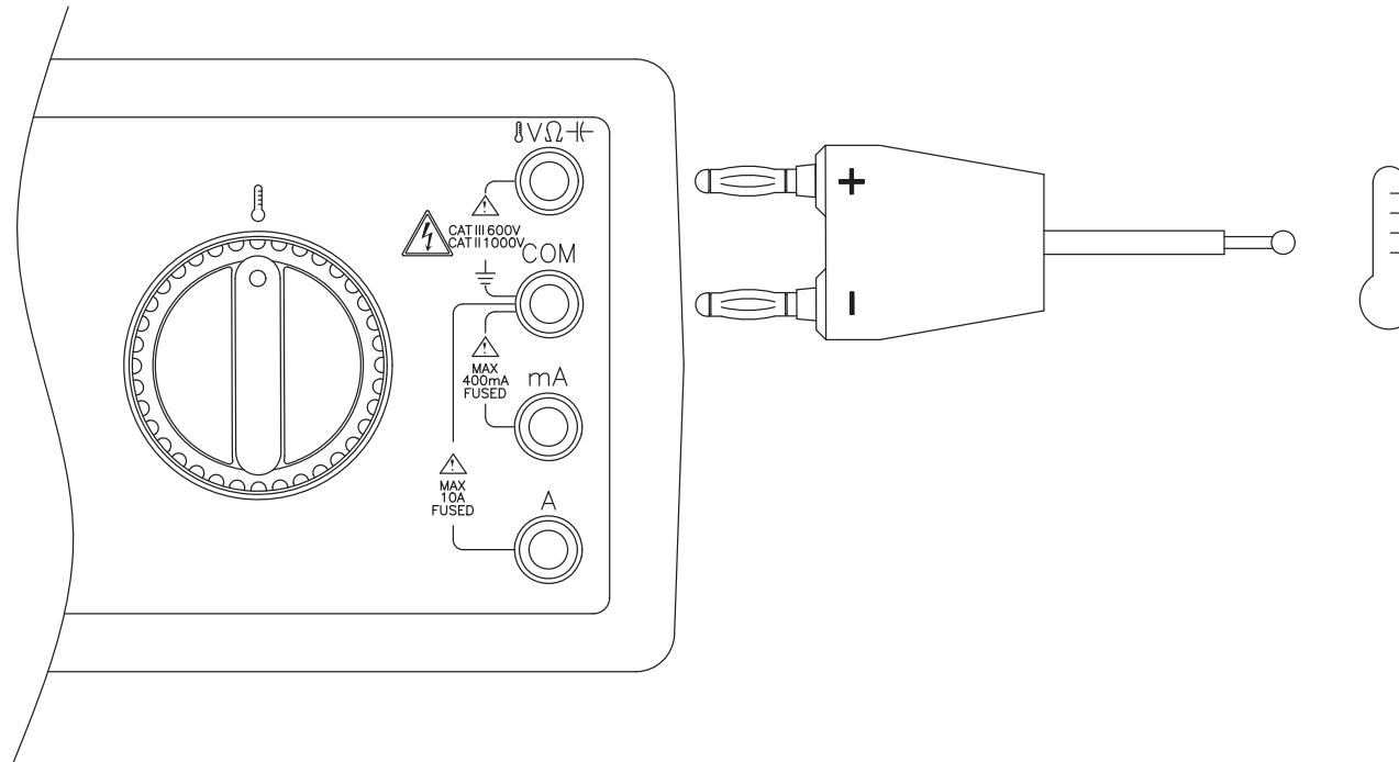
仪表可测量 K 型热电偶的温度。按下(蓝色)功能钮选择摄氏( $^{\circ}\text{C}$ )或华氏( $^{\circ}\text{F}$ )。
