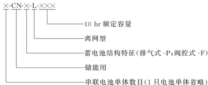
图 1 铅酸蓄电池型号编制方法示意图
