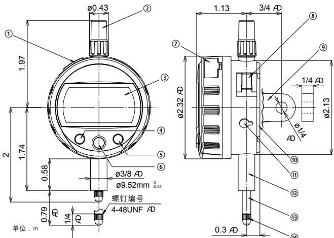
AD 这是美国量具设计(AGD)的标志。这意味着此类型符合 ASME/AGD 2 中指针对指示表的适当尺寸,并具有可互换性。仅适用于带有E或T后缀的型号
