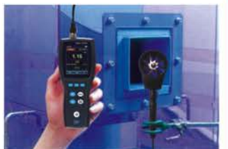
管道出风口测试
