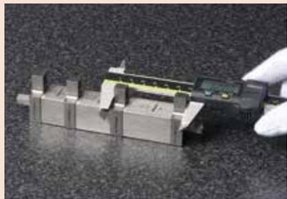
使用平头量爪、量块、拉杆和滚花螺钉组成量具附件套装，可在卡尺选定位置快速进行精度的测量。
