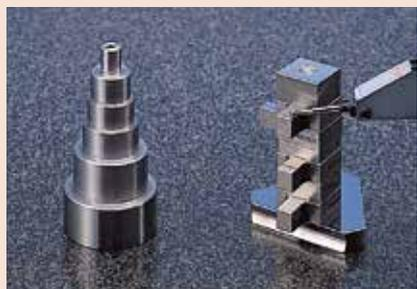
使用平头量爪、量块、拉杆和滚花螺钉组成量具附件套装，可以对阶差工件进行快速比较测量。
