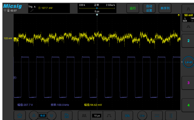
CH1: 在 100kHz, 207.7V 信号下输出的共模信号幅度 94.62mV, 共模抑制比 >-60dB
