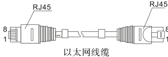
RJ45端口支持自动MDI/MDI-X操作，可以使用直通线连接PC或服务，连接其它交换机或集线器。在直通线（MDI）中，管脚1、2、3、4、5、6、7、8对应连接；对于交换机或集线器的MDI-X端口，采用的是交叉线：1→3、2→6、3→1、6→2、4→7、5→8、7→4、8→5。10/100/1000Base-T引脚定义如下表所示：
