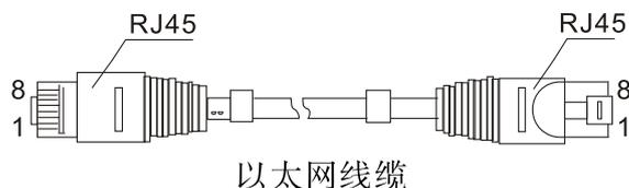
RJ45端口支持自动MDI/MDI-X操作，可以使用直通线连接PC或服务器，连接其它交换机或集线器。在直通线（MDI）中，管脚1、2、3、6对应连接；对于交换机或集线器的MDI-X端口，采用的是交叉线：1→3、2→6、3→1、6→2。MDI/MDI-X应用中10/100Base-T (X)引脚定义如下表所示。
