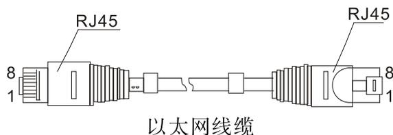
RJ45端口支持自动MDI/MDI-X操作，可以使用直通线连接PC或服务器，连接其它交换机或集线器。在直通线（MDI）中，管脚1、2、3、4、5、6、7、8对应连接；对于交换机或集线器的MDI-X端口，采用的是交叉线：1→3、2→6、3→1、6→2、4→7、5→8、7→4、8→5。10/100/1000Base-T引脚定义如下表所示：
