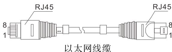
RJ45端口支持自动MDI/MDI-X操作，可以使用直通线连接PC或服务器，连接其它交换机或集线器。在直通线（MDI）中，管脚1、2、3、4、5、6、7、8对应连接；对于交换机或集线器的MDI-X端口，采用的是交叉线：1→3、2→6、3→1、6→2、4→7、5→8、7→4、8→5。10/100/1000Base-T引脚定义如下表所示：
