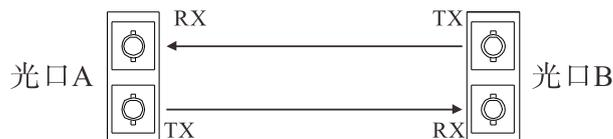
注意：用光纤跳线连接两个光口A和B，将光口A的TX连接到光口B的RX，将光口A的RX连接到光口B的TX的，保证光纤跳线的正确使用。
