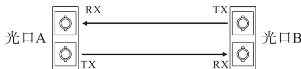
注意：用光纤跳线连接两个光口A和B，将光口A的TX连接到光口B的RX，将光口A的RX连接到光口B的TX的，保证光纤跳线的正确使用。
