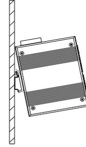
第三步：用螺钉将安装导轨卡槽固定在导轨两端的固定导槽上，保证导轨与交换机垂直稳定地固定在导轨上。
