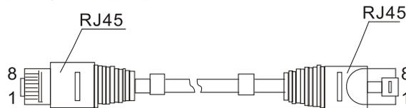
RJ45端口支持自动MDI/MDI-X操作，可以使用直通线连接PC或服务器，连接其它交换机或集线器。在直通线（MDI）中，管脚1、2、3、6对应连接；对于交换机或集线器的MDI-X端口，采用的是交叉线：1→3、2→6、3→1、6→2。MDI/MDI-X应用中10/100Base-T (X) 引脚定义如下表所示。
