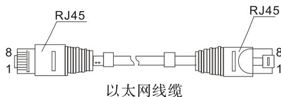
RJ45端口支持自动MDI/MDI-X操作，可以使用直通线连接PC或服务器，连接其它交换机或集线器。在直通线（MDI）中，管脚1、2、3、6对应连接；对于交换机或集线器的MDI-X端口，采用的是交叉线：1→3、2→6、3→1、6→2。MDI/MDI-X应用中10/100Base-T(X)引脚定义如下表所示。
