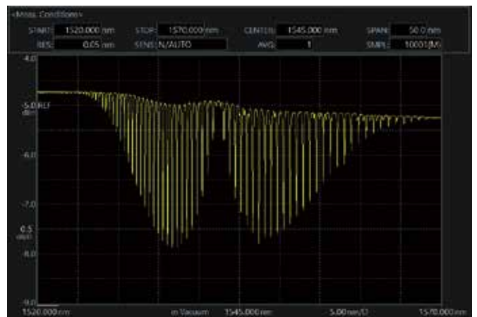
氨化氢 \text{H}_3\text{C}_{14}\text{N} 的吸收光谱测量(AQ6375E)
