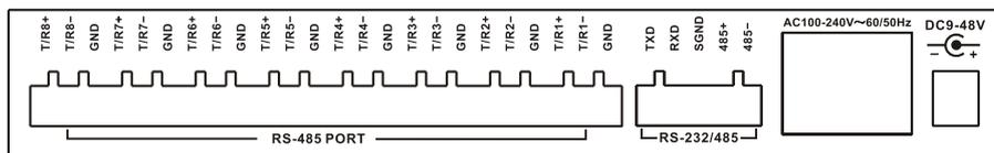
图 2 UT-1208H后面板示意图
