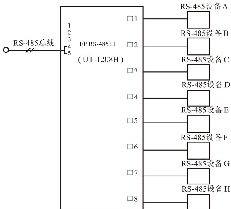
3、主控机串口（RS-232C）至多个高可靠性的 RS-485接口的应用。或已有RS-485总线扩展至多个高可靠性的RS-485接口的应用，在RS-485总线上可同时并连128个RS-485集线器。
