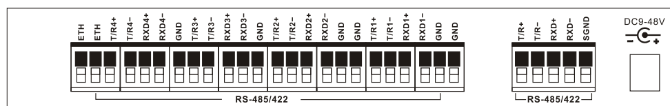
图 1 UT-1304前面板示意图
