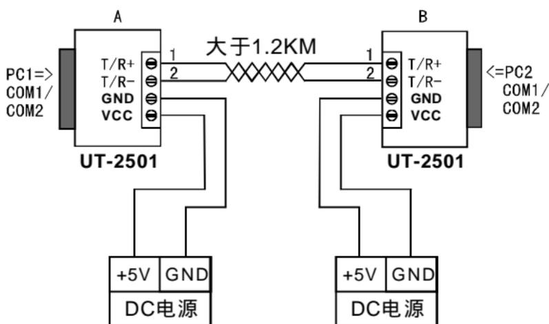
注：CAN 通讯线可以使用双绞线、屏蔽双绞线。若通讯距离超过 1.2KM 时，应保证线的截面积大于1.0mm。具体规格，应根据距离而定，常规是随距离的加长而适当加大。
