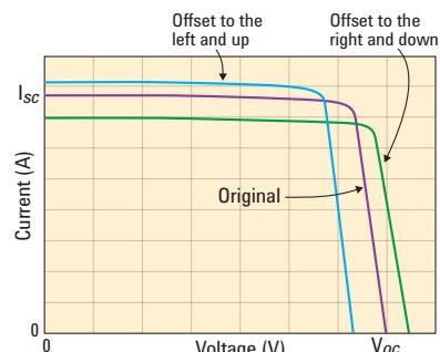
E4360 产生的 I-V 曲线的电流和电压列表可以调整，但不能改变其基本形状。如果在改变工作条件时，被模拟模块产生的 I-V 曲线能够保持基本形状，那么这一基本形状就可作为模板使用。偏置值施加到您原先通过内插所产生的内部表格的原始 I-V 数据组上。可通过编程加减电压、电流偏置，从而有效地模拟变化的光照和温度条件，而不需要另外送入曲线数据。请参看图 4。
