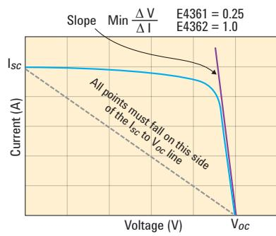
E4360 能够接受等效于短路电流的最大功率点电流 ( $I_{mp}$ )。最大功率点电压 ( $V_{mp}$ ) 必须小于开路电压 ( $V_{oc}$ )。曲线必须是单调下降的，也必须落在  $I_{sc}$  至  $V_{oc}$  连线的上面，所得到曲线每一点的斜率（用  $\Delta V / \Delta I$  表示）必须符合最小值的要求。见图 3。E4360 检查整条曲线的单调性，以及在  $V_{oc}$  终止时的斜率。
