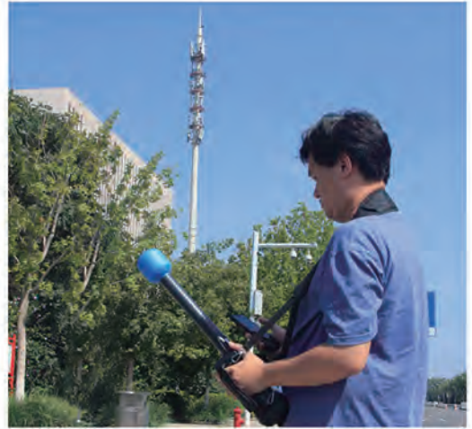
现场基站安装、调试检测电磁辐射信号
