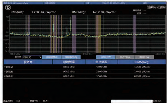
图2 中国移动、中国联通、中国电信的各自功率和总功率密度，以及频谱分布图
