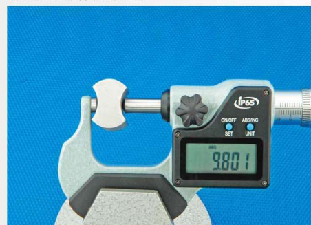
测量异型零件根部尺寸
