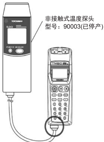
非接触式温度探头连接到输入通道“D”的示例
