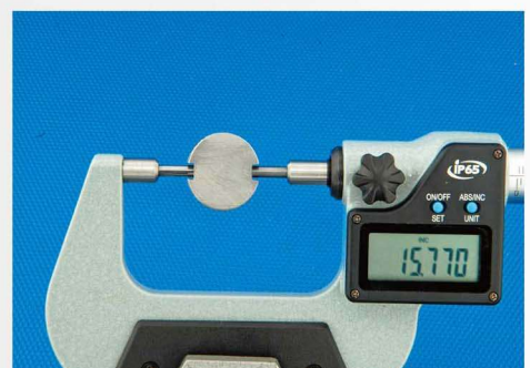
测量键槽根部尺寸
