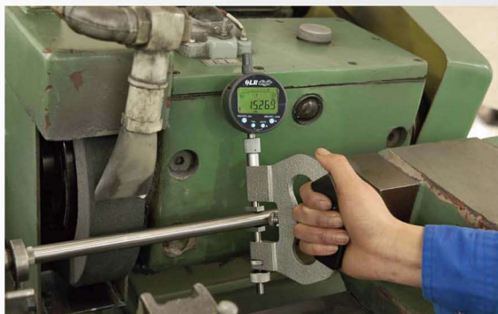
现场测量零件直径
