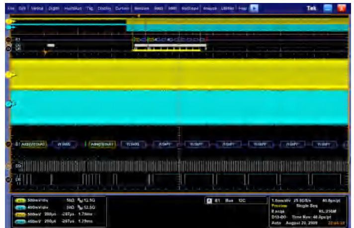
以 25 GS/s 捕获 10 ms 时长内同时发生的高速和低速信号。
