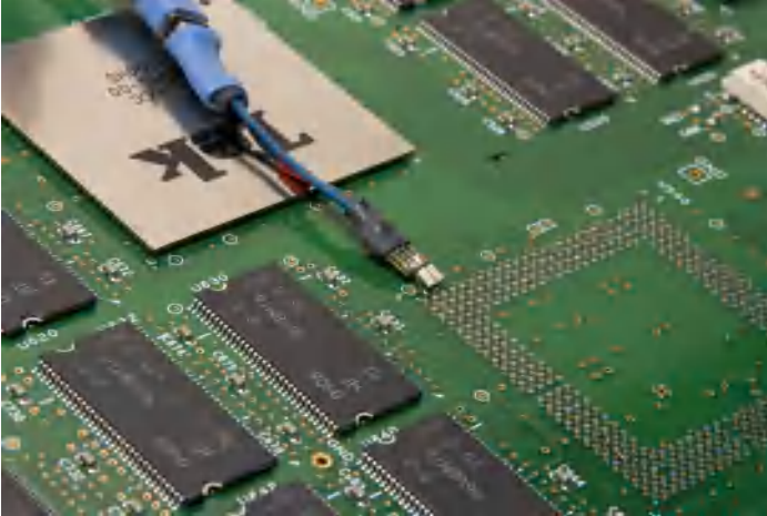
P7500 TriMode™ 探头使用低成本的焊接式探测尖端，可以迅速连接，这样在多个焊接点之间移动探头可以变得快速而简便。
