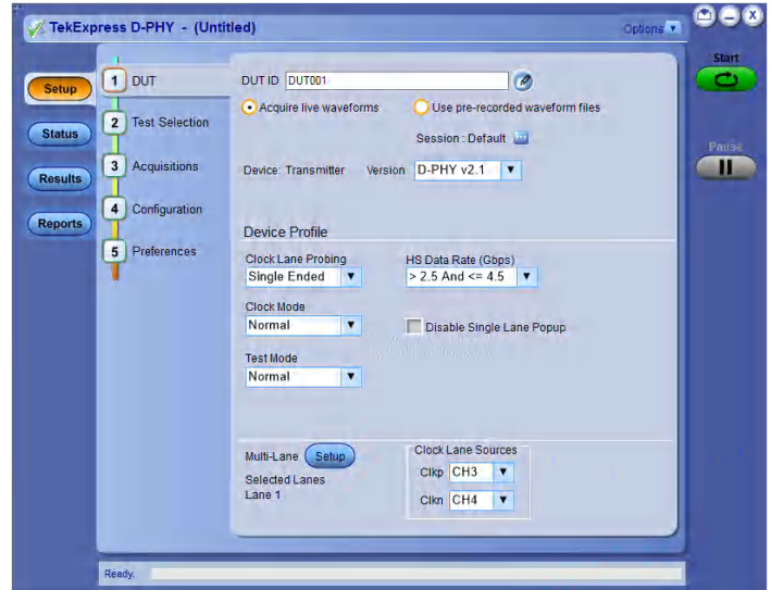
TekExpress D-PHY (选项DPHY12、DPHY21) - TekExpress® D-PHY 应用针对发射机符合性和特征提供了完整的物理层测试解决方案, 如MIPI D-PHY 版本1.2 和版本2.1 规范中所定义。该自动化测试解决方案提供了一种简易的方式来测试、调试和表征D-PHY 数据链路的电气和定时测量。
