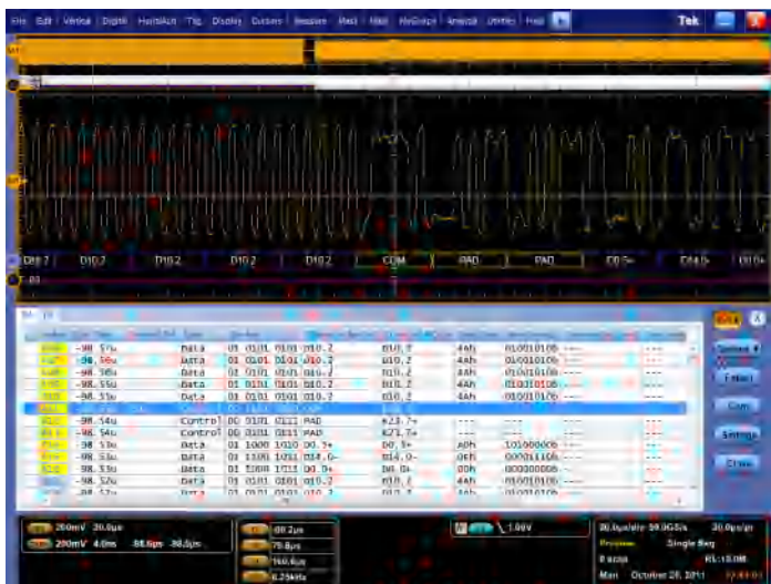
HSS 总线的协议和电子视图。结果表格中的数据与采集的波形进行了时间关联, 从而增强了识别电子信号引起的协议错误的可能原因的能力。
