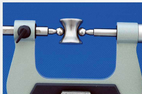
测量异形零件根部尺寸
