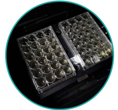
具备两个培养板位,多种适配器可兼容不同规格的培养板,最高可同时处理192个样本。
