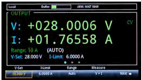
主屏幕最上面一行显示状态和事件指示器。可以选择这些选项以打开对话框，并获得更多状态或事件信息。
