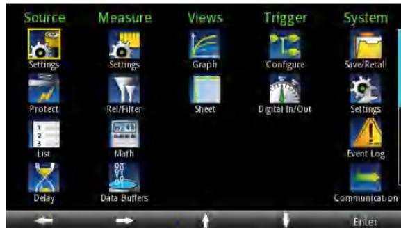
在此屏幕中，可以选择信号源、测量、绘图、触发和系统设置菜单。您可以通过这些菜单来选择针对您的应用的选项并设置仪器。要选择设置项，可以滚动导航旋钮或者使用箭头键选择相应的图标。然后按 **ENTER**。
