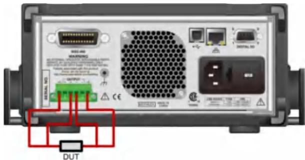
进行连接后，用电缆防护外壳盖住输出对接连接器和电线。
