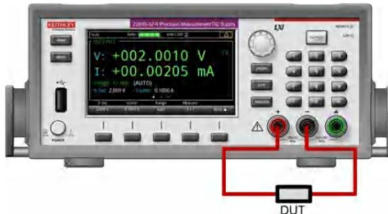
后面板的两线（本地感应）DUT 连接
