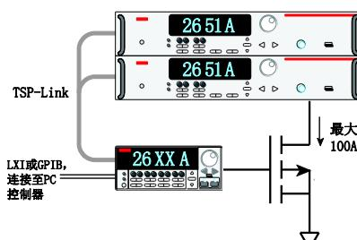
吉时利的 TSP 和 TSP-Link 技术确保实现真正的 SMU-per-pin 测试，不存在基于主机系统的功率和/或通道限制。
