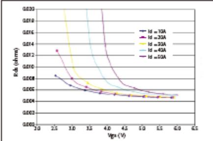
1μV 测量分辨率和高达 50A (2 个单元可达 100A) 的电流源输出确保低电平 Rds 测量，支持新一代器件。
