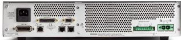
2651A 型支持 GPIB、LXI、数字 I/O, 以及吉时利的 TSP-Link, 用于多通道同步。
