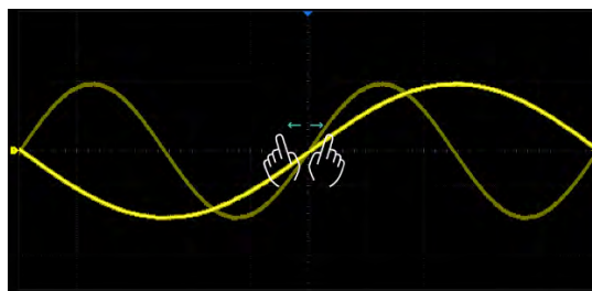
通过水平方向的两点缩放手势控制波形的水平档位
