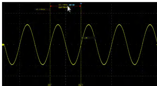
将手指或鼠标放到 \Delta X （或 \Delta y ）显示区域后单点移动控制两根光标一起移动
