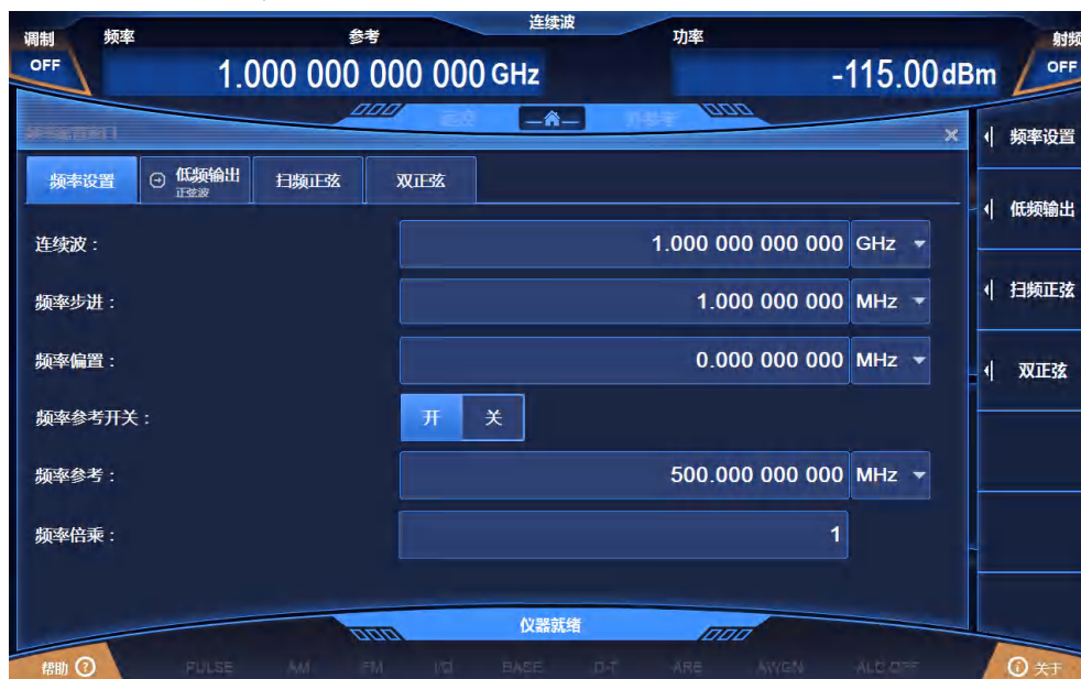
图 3.17 设置频率参考 500MHz
