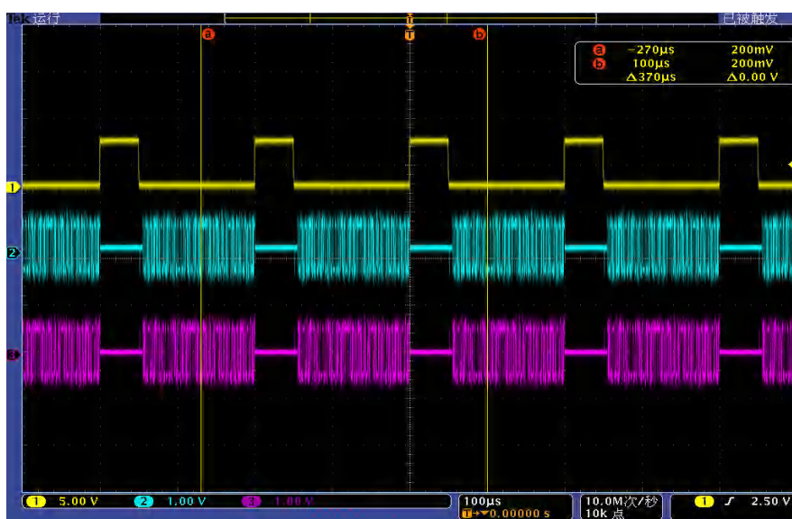
图 4.26 基带触发示意图 (门控 低有效)
