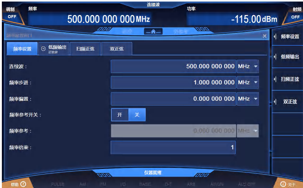
图 3.16 设置连续波 500MHz，频率步进 1MHz，步进频率
