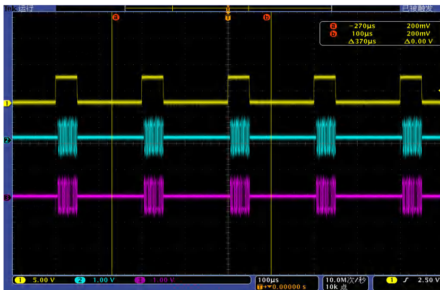
图 4.25 基带触发示意图 (门控 高有效)
