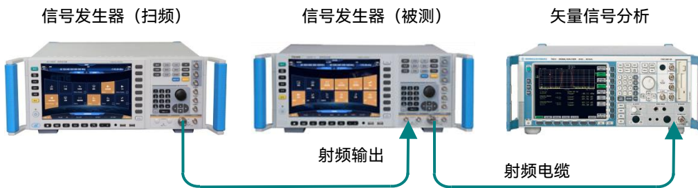
图 8.10 外部调频频响测试
