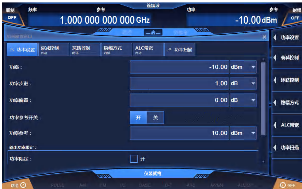
图 3.20 功率电平 0dBm，功率参考 10dBm
