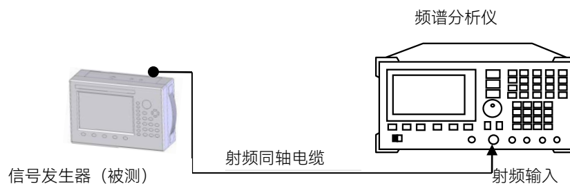
7.4 单边带相位噪声测试框图
