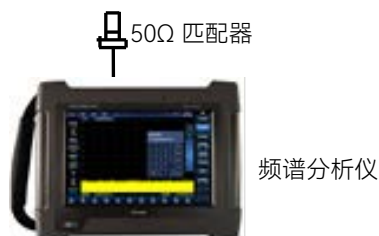
图 16.9 显示平均噪声电平测试设置
