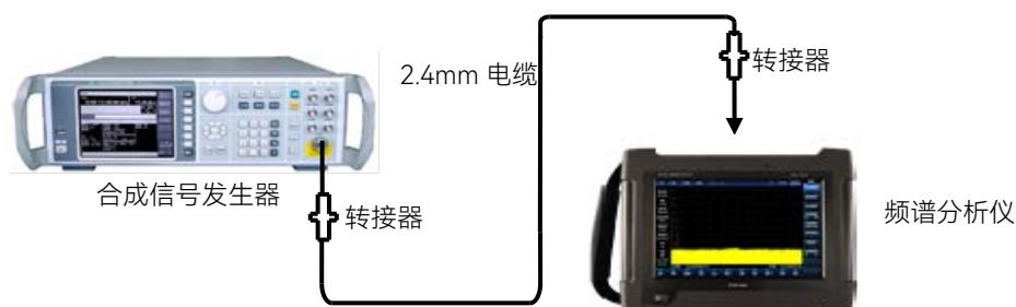
图 4.1 信号发生器与频谱分析仪的连接示意图
