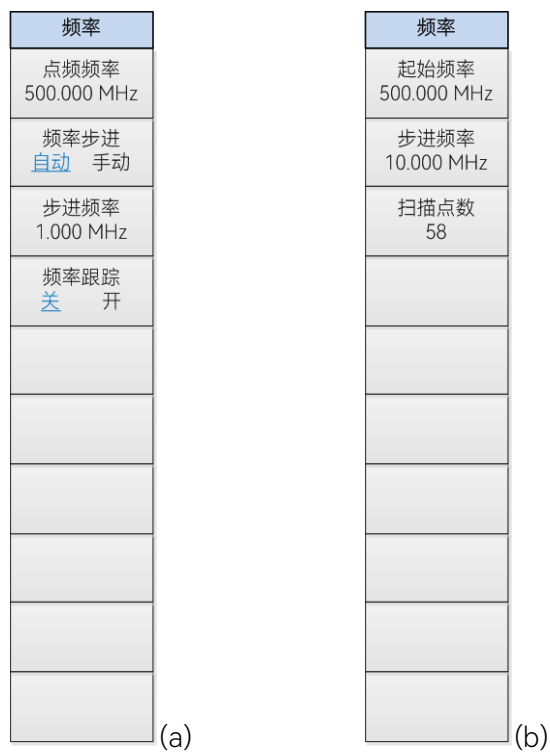
图 10.4 场强测量模式频率菜单结构框图: (a)点频测量; (b)频率测量
