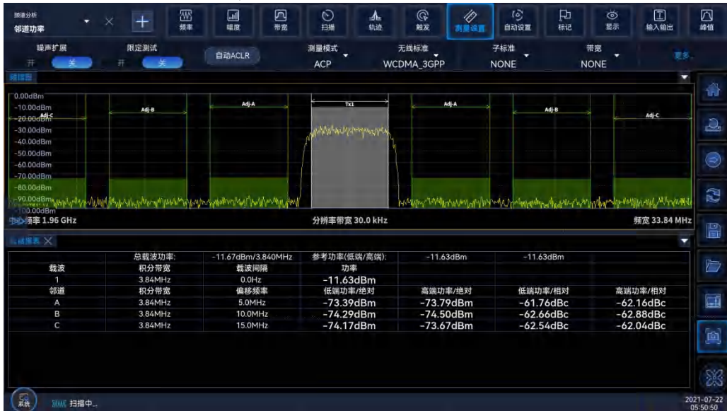
图 4.14 测量第三邻道
