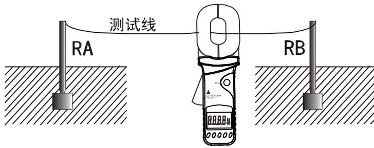
由于钳表所测的阻值是两个接地电阻和测试线阻值的串联值。
