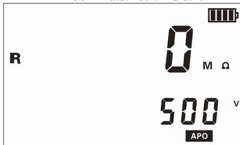
图 9-4 绝缘电阻测量模式
