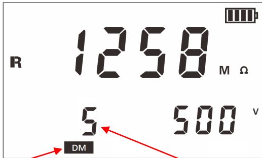
图 12-1 锁定并保存显示 锁定标识符 存储索引值
