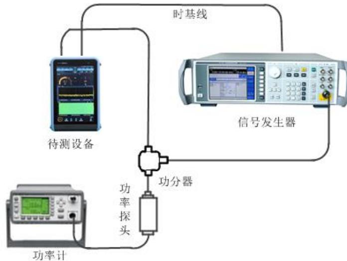
图 8.12 中频抑制的测试示意图
