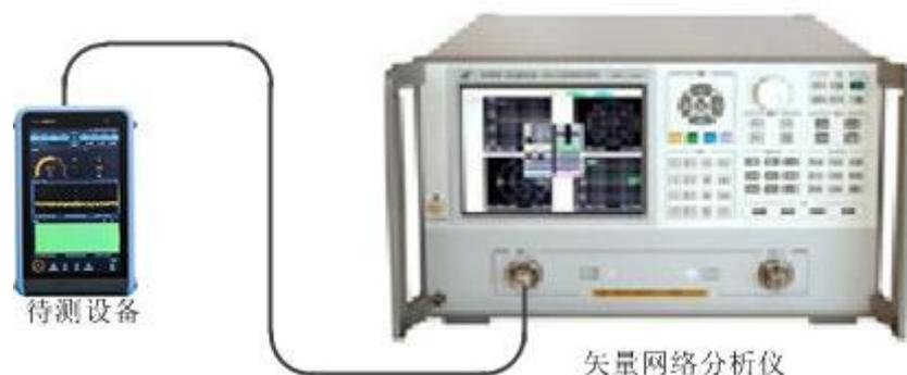
图 8.3 输入端口驻波比测试示意图
