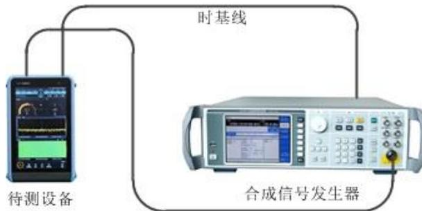
图 8.15 全景扫描速度测试示意图
