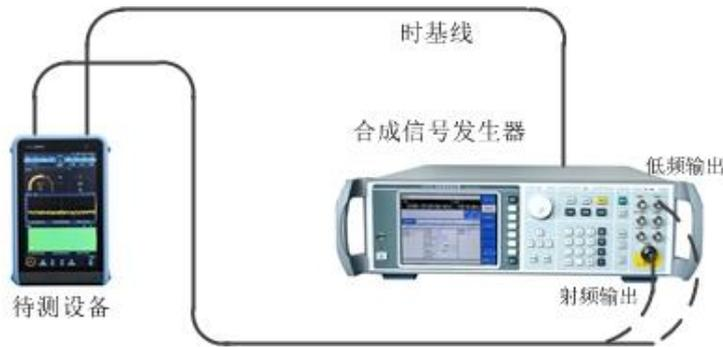
图 8.1 频率范围测试示意图
