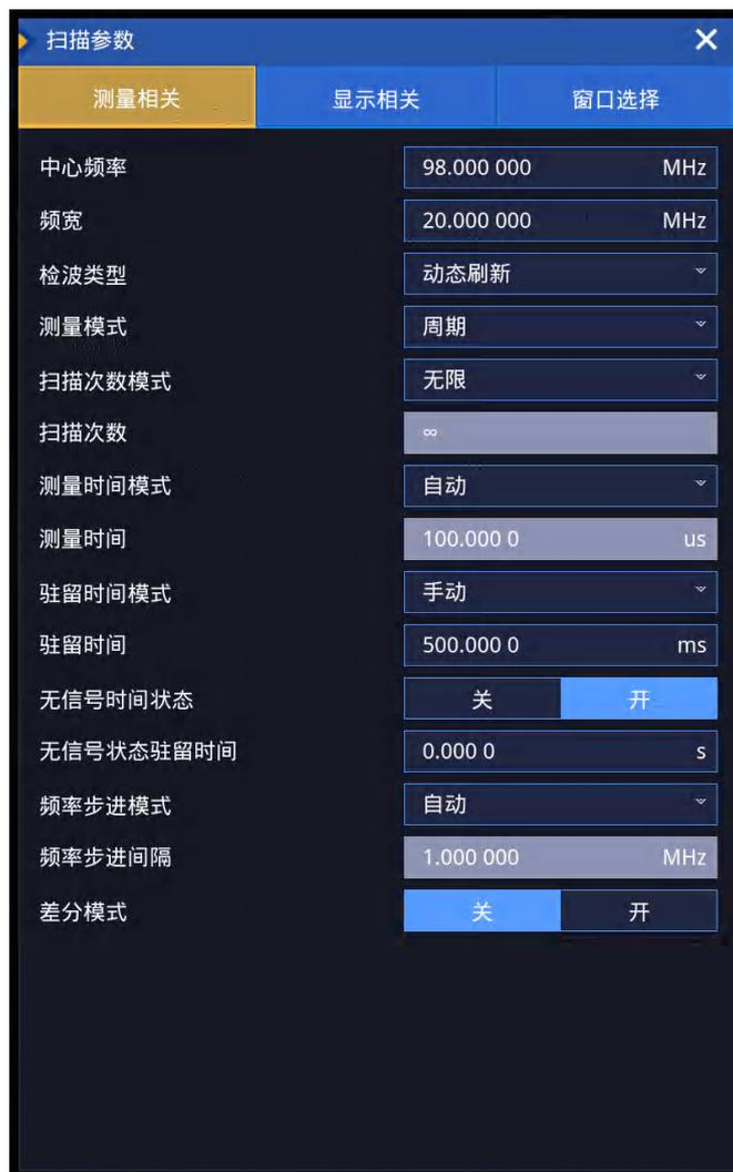
图 5.47 射频全景窗口对应的测量相关属性页
