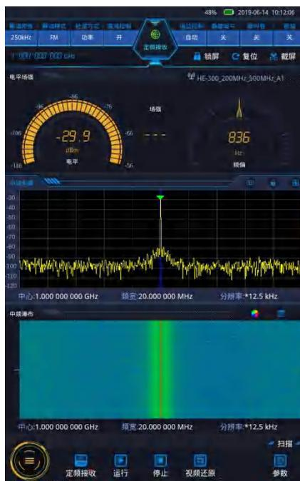
图 3.16 正弦信号测量结果
