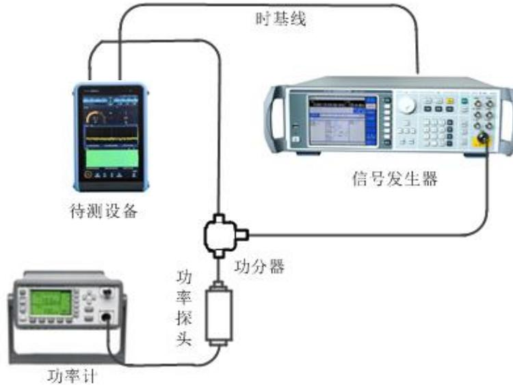
图 8.10 镜频抑制的测试示意图
