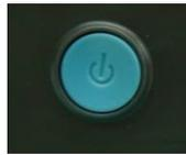
图 3.5 侧面板电源开关
