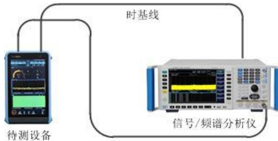
图 8.13 本振再辐射测试示意图
