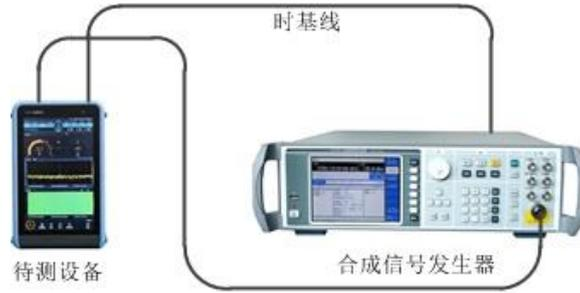
图 8.6 相位噪声测试示意图
