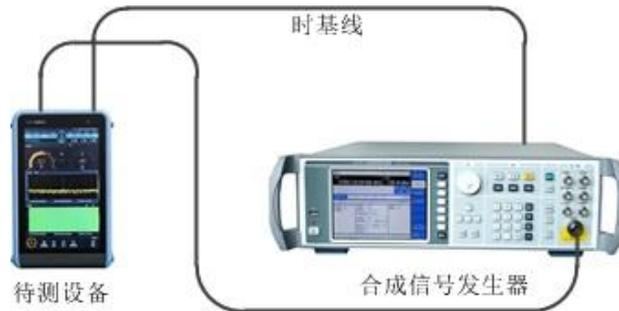
图 8.2 最大线性工作电平测试示意图
