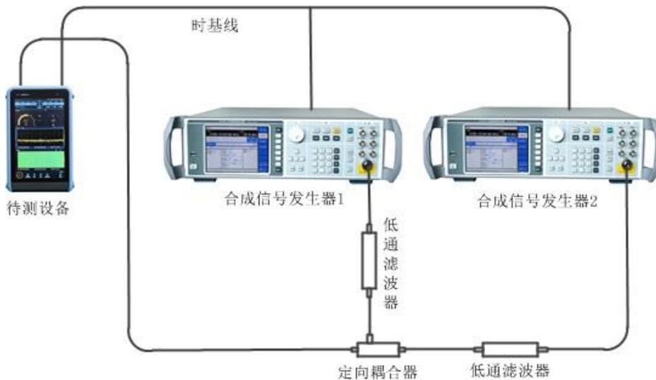
图 8.9 三阶截获点测试示意图
