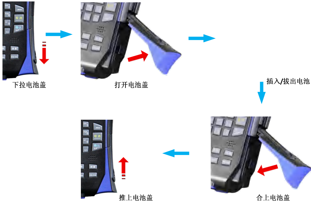
图 3.22 安装及更换电池步骤
