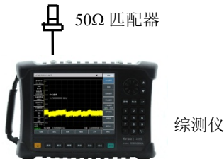
图16-12 显示平均噪声电平测试设置
