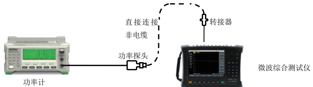
图16-3 功率电平精度测试框图
