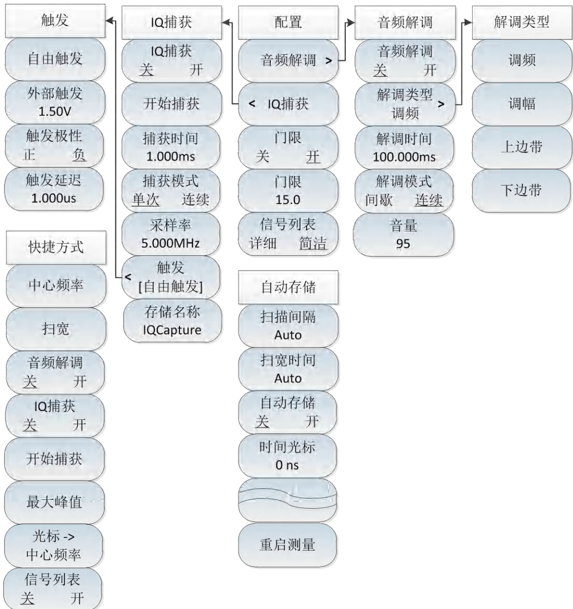
图 14-6 信号分析整体菜单框图续
