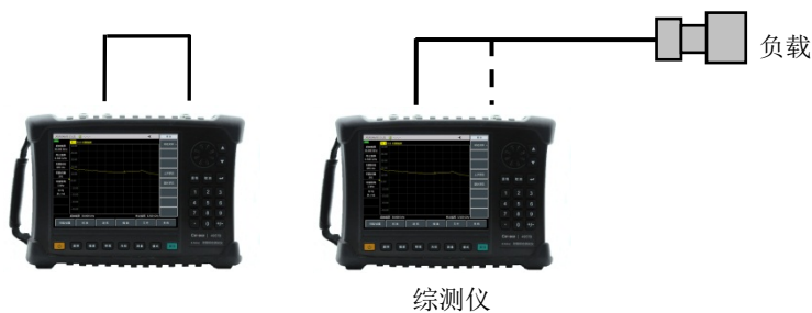
图16-6 动态范围、传输跟踪测试框图
