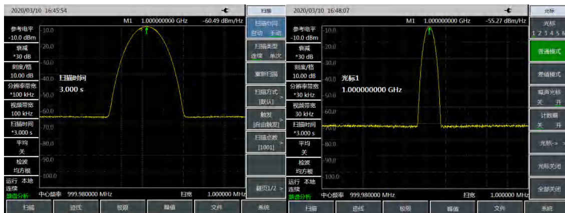
图5-11 使用噪声光标功能测量噪声
