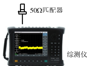
图16-15 剩余响应测试设置
