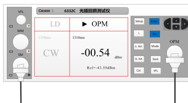
图 4.13 光功率计模式测试示意图
