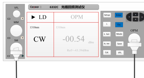
图 4.12 光源模式测试示意图
