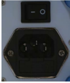
图 3.1 6332C 光插回损测试仪后面板电源开关和插座
