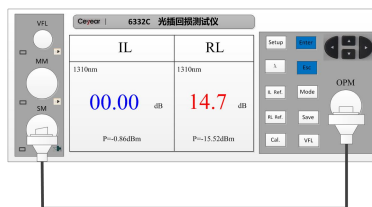
图 4.14 插损参考测试示意图
