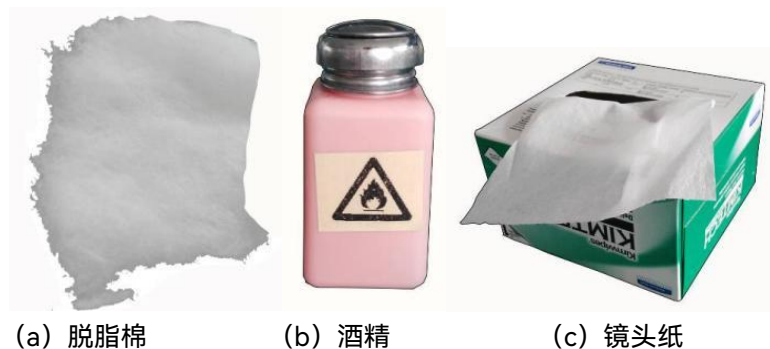
图 F-11 清洁光纤端面所需器材
