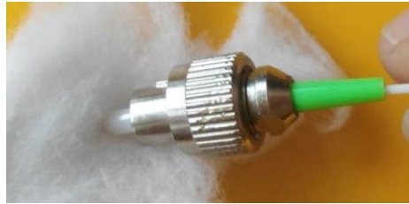
图 F-12 酒精棉擦拭光纤接头
