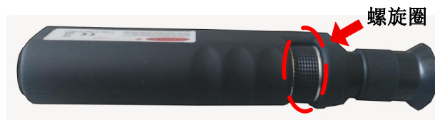
图 F-8 螺旋圈位置
