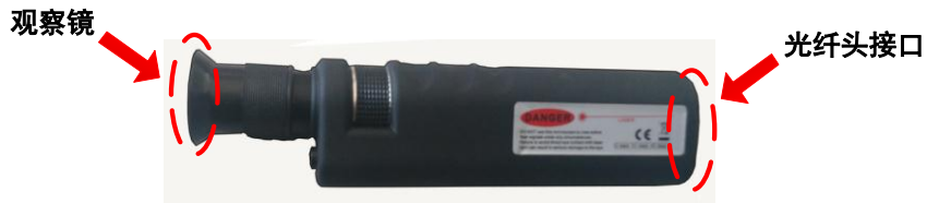
图 F-4 光纤端面检查仪
