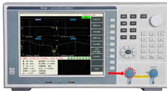
图 G-6 带保护套的 VFL 接口
