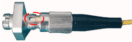
图 D-10 FC/UPC 接口凸起与法兰盘接口凹陷处对齐
