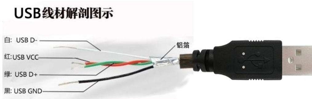
图 2.5 USB 连接线各线定义
